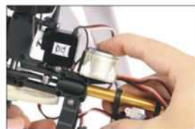
8. 将陀螺仪固定好 Fix the GYRO.
